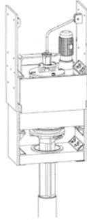
**Figura 1.** Desenho esquemático do sistema de sustentação e giro da lança rotativa.
