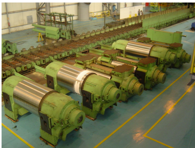
Figura 8. Exemplo de posicionamento dos cilindros de encosto na linha de laminação durante planejamento da troca.
