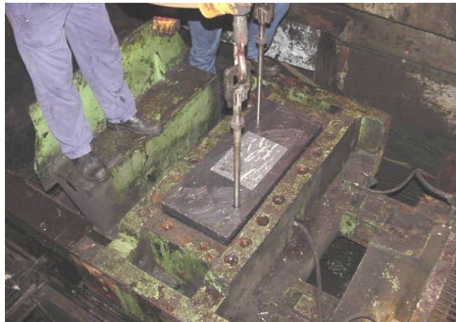
Figura 12. Novos calços inferiores das cadeiras do Trem Acabador permitem a troca conjunta de todos os calços de cada lado da cadeira; isso representou uma redução no tempo de troca de 30 para 7 minutos por cadeira.
