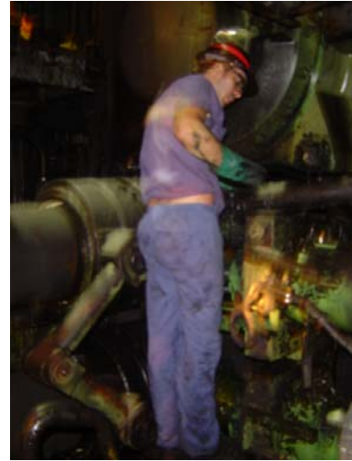
Figura 5. Situação da área de acionamento do Trem Acabador até Março de 2005. Não havia local adequado para o apoio do operador o que além de proporcionar uma condição insegura, elevava o tempo de desconexão das mangueiras de
