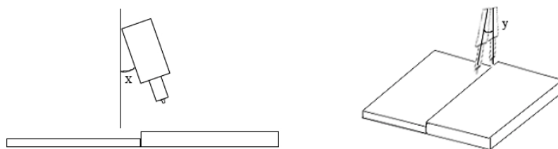
Figura 2. Ângulos de soldagem X e Y.
