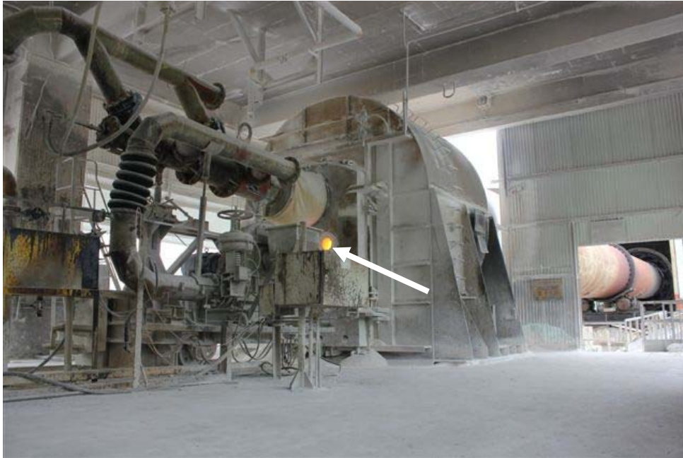
Figura 2. Janela de acesso utilizada para as medições de temperatura da chama.
