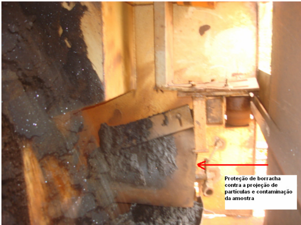
Figura 17 – proteção contra projeção de partículas
