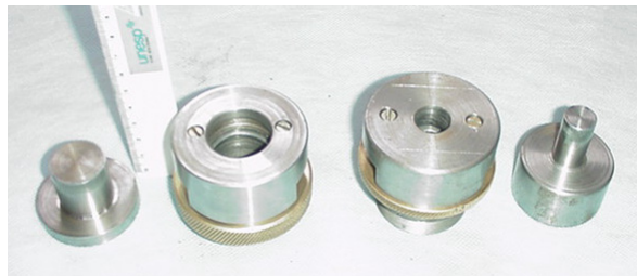
Figura 1. Punções e matrizes para o puncionamento de tiras de alumínio.
