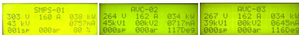
Figura 9. Leitura de KV x mA para os 3 campos elétricos com o "mid frequency device".
