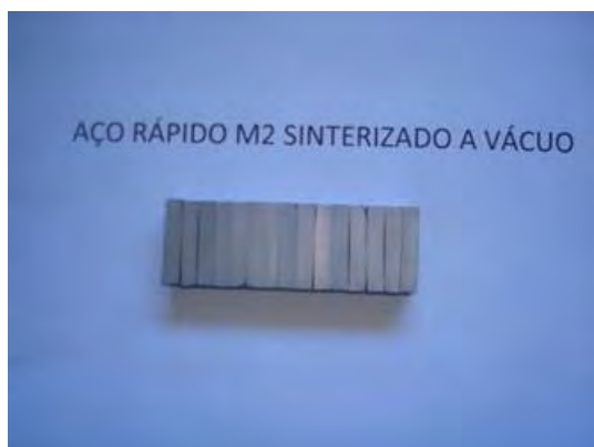
Figura 10. Pastilhas do aço rápido M2 sem reforço de NbC sinterizado a vácuo.
