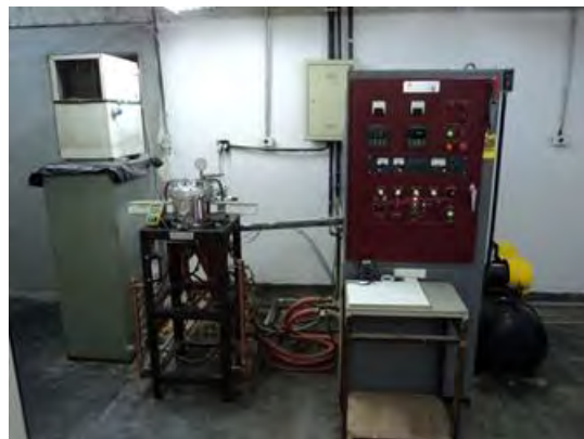
Figura 5. Forno a vácuo do Departamento de Engenharia Mecânica da UFRN ( 10^{-5} Torr.)
