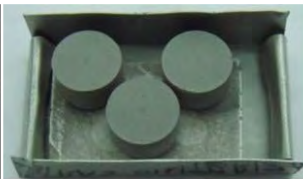
Figura 15. Pastilhas sinterizadas do aço rápido AISI M3:2 com adição de carboneto de nióbio (NbC).
