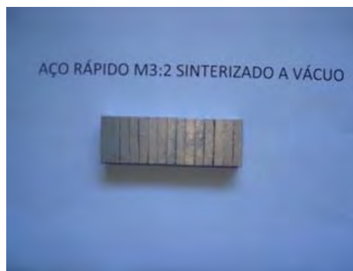
Figura 11. Pastilhas do aço rápido M3:2 sem reforço de NbC sinterizado a vácuo.
