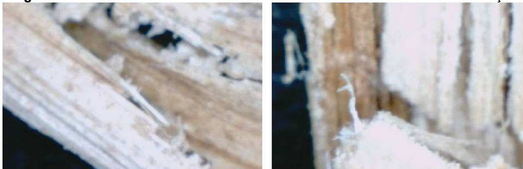
Figura 4. Vista da região de fratura após o ensaio de tração da fibra sem tratamento
