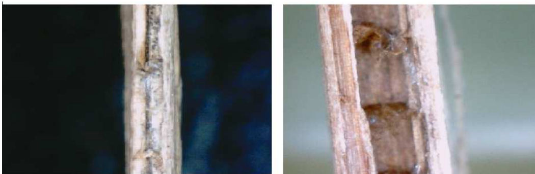
Figura 3. Vistas de duas amostras de fibra sem tratamento antes do ensaio de tração.
