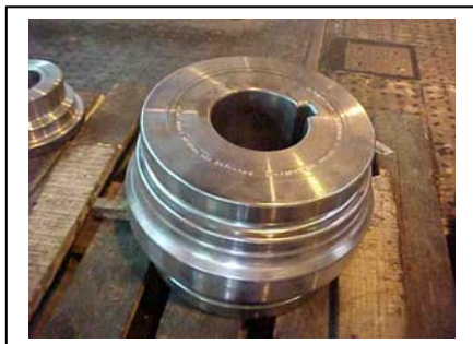
Figura 1. Rolo para conformação a frio de rodas de aço. Aço: AISI D2 (BRASIMET)
