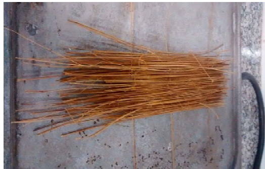
Figura 2: Fibras de bambu após a mercerização
