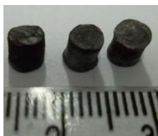
Figura 2. Amostras sinterizadas obtidas a partir da sinterização com 3 ciclos.
