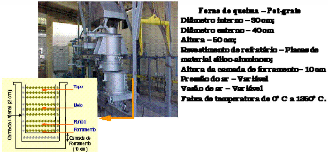
Figura 4. Desenho esquemático, foto e dados do Pot Grate – Forno piloto para queima de pelotas.
