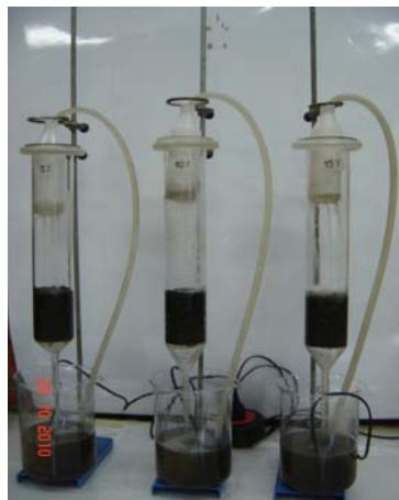
Figura 1. Reatores de lixiviação com recirculação do material lixiviado.
