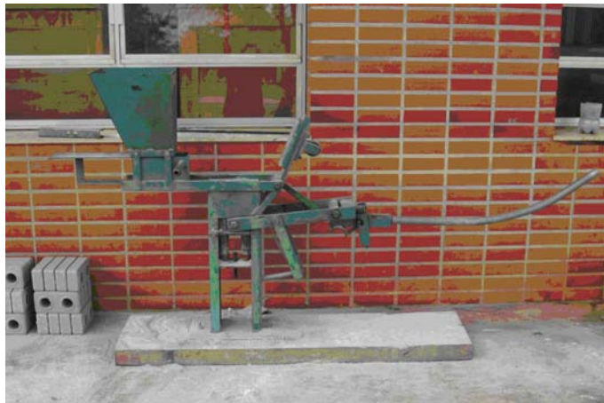
Figura 2 – Máquina utilizada na fabricação dos tijolos
