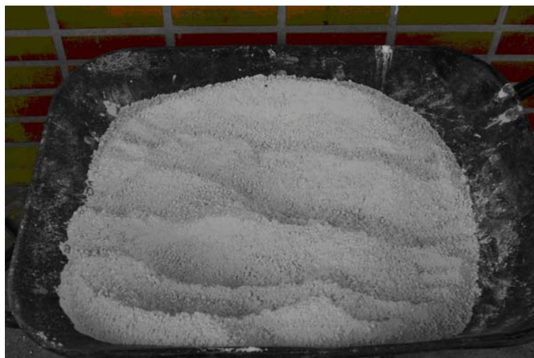
Figura 1 – Pó de mármore utilizado na fabricação dos tijolos
