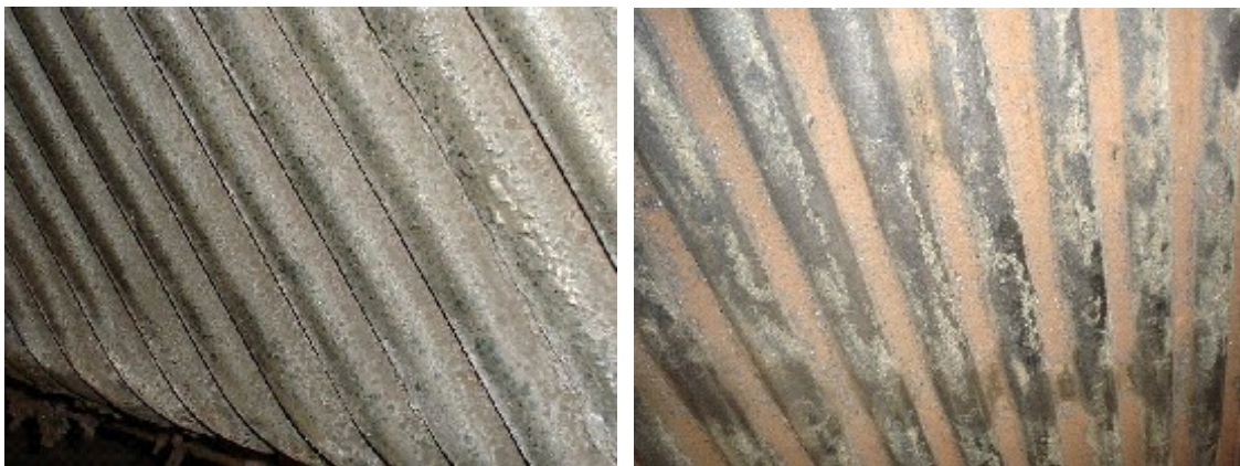
Figura 11. Resultados Metalizado Base Cr-Ni luego de 1 y 2 campañas de convertidor.
