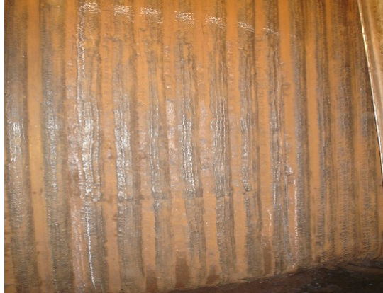
Figura 10. Resultados Relleno 625 Base Cr-Ni-Mo luego de 2 campañas de convertidor.
