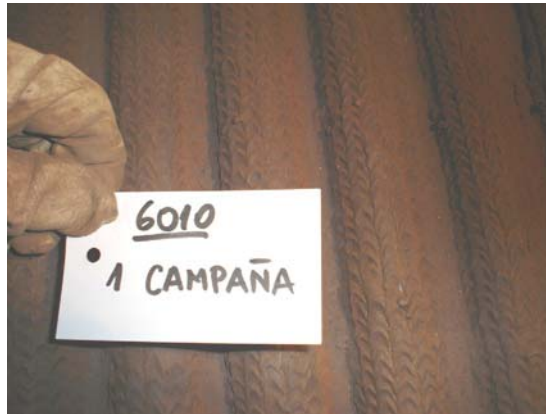
Figura 12. Resultados Relleno ampliado de Soldadura E-6010 luego de una campaña de convertidor.
