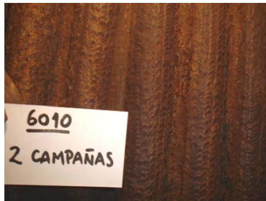
Figura 9. Resultados 2ª experiencia con soldadura E-6010 después de 2 campañas.
