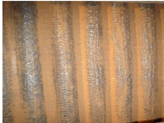
Figura 7. Segunda ampliación de relleno soldadura E-6010 en campana móvil.
