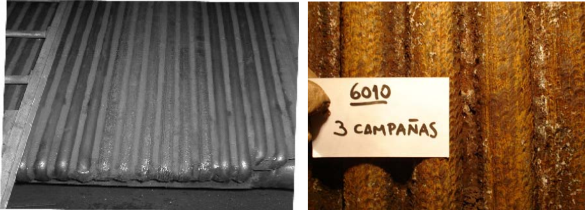
Figura 8. Resultados 1ª experiencia con soldadura E-6010 después de 1 (izq) y 3 campañas (der).
