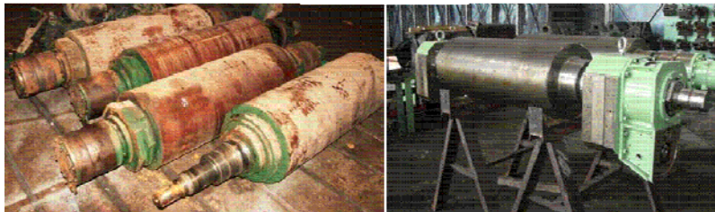
Figura 8 – Rolos originais e atuais inteiriços montados com os mancais.
