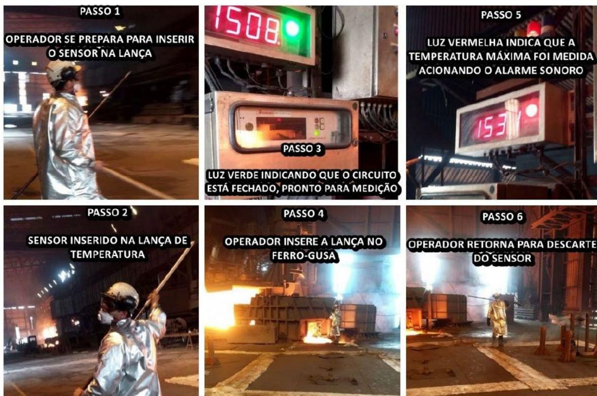
**Figura 1.** Etapas da medição de temperatura do ferro-gusa no pocinho pelo operador.
