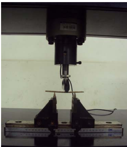
Figura 8 – Ensaio de flexão em 3 pontos
