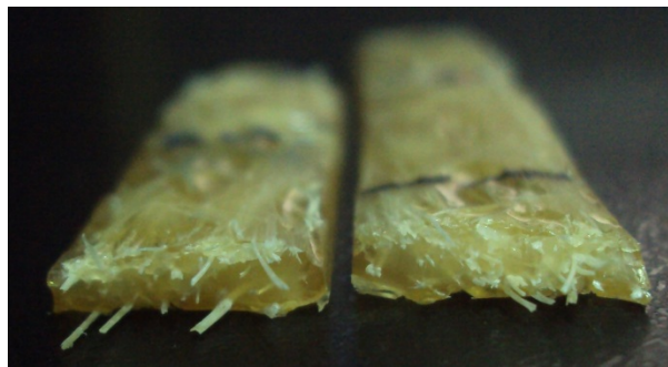
Figura 10. Amostra de sisal pós-ruptura.
