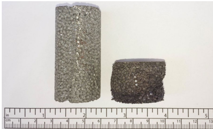
Figura 6. À esquerda, uma amostra antes de ser submetida ao ensaio, à direita uma amostra após o ensaio a 300 °C – 30 min. A coloração azul se evidenciou após a exposição à temperatura elevada.
