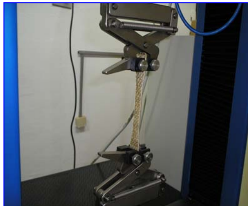
Figura 4: Corpo de prova submetido a ensaio de tração.
