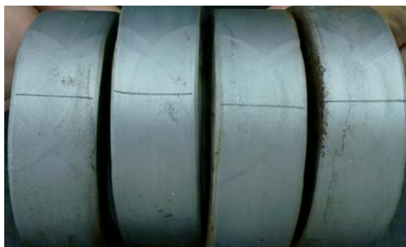
Figura 8. Amostras de dobramento guiado de juntas longitudinais com ausência de trincas.
