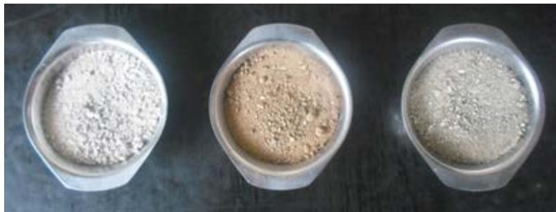
**Figura 3.**Aspecto visual das areias (agregados miúdos) utilizadas na confecção dos CP's deste estudo. Da esquerda para direita: Buritiba (B); Juquiá (J) e Mogi das Cruzes (M).
