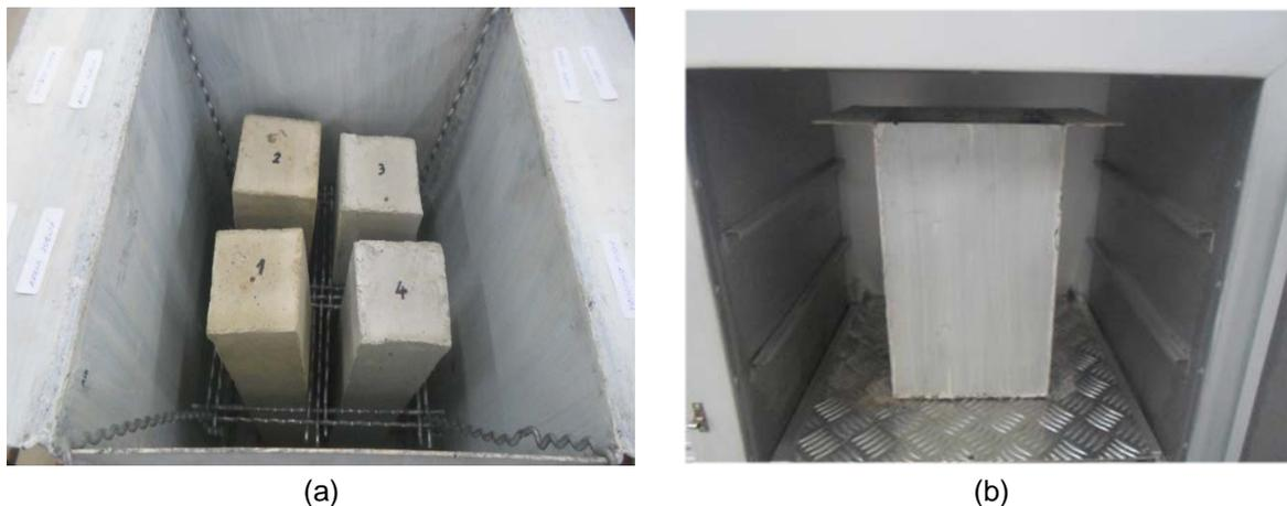
**Figura 2.** Corpos de Prova submetidos ao ensaio de imersão pelo método acelerado da RAA: (a) posicionamento dentro do tanque (sem a solução), posicionamento do tanque dentro da estufa.
