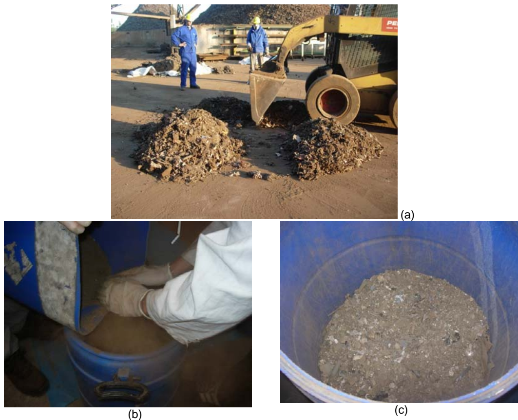
Figura 1. Fotografias mostrando o aspecto geral do fluff antes e após a separação granulométrica. (a) Resíduo do triturador de sucata – fluff ; (b) fração abaixo de 2 mm; e (c) fração acima de 2 mm.
