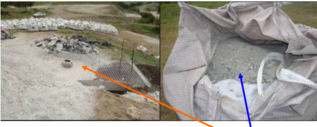
Figura 3 – Planta de beneficiamento que separa o aço da escória de panela.
