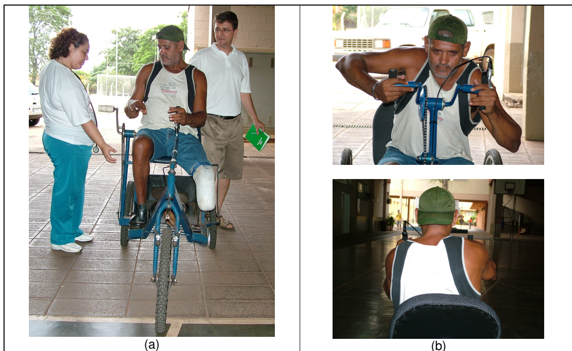
Figura 1. O dimensionamento do posto de trabalho para postura sentada no triciclo construído e testado pelo voluntário não é o correto, pois com a mão esquerda ele pilota e com a direita impulsiona o triciclo sem cuidados ergonômicos (a). Isto tem produzido atrofiamento do lado esquerdo e escoliose (b).
