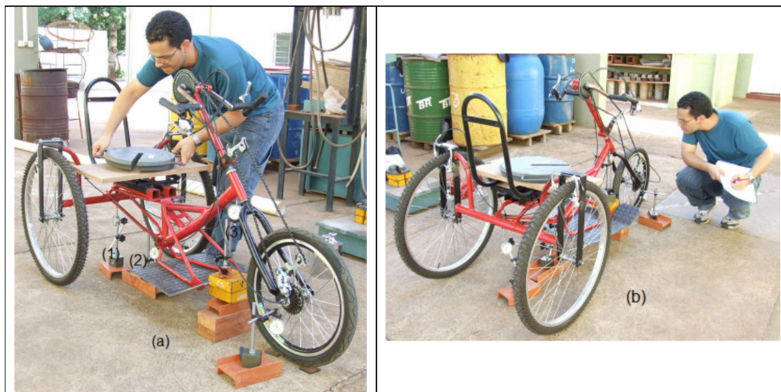
Figura 5. Ensaio de deflexão do quadro, mostrando os relógios comparadores em diferentes posições (a); e leitura da deflexão (b).
