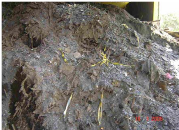
Figura 5 – Carepa contaminada do LQT2
