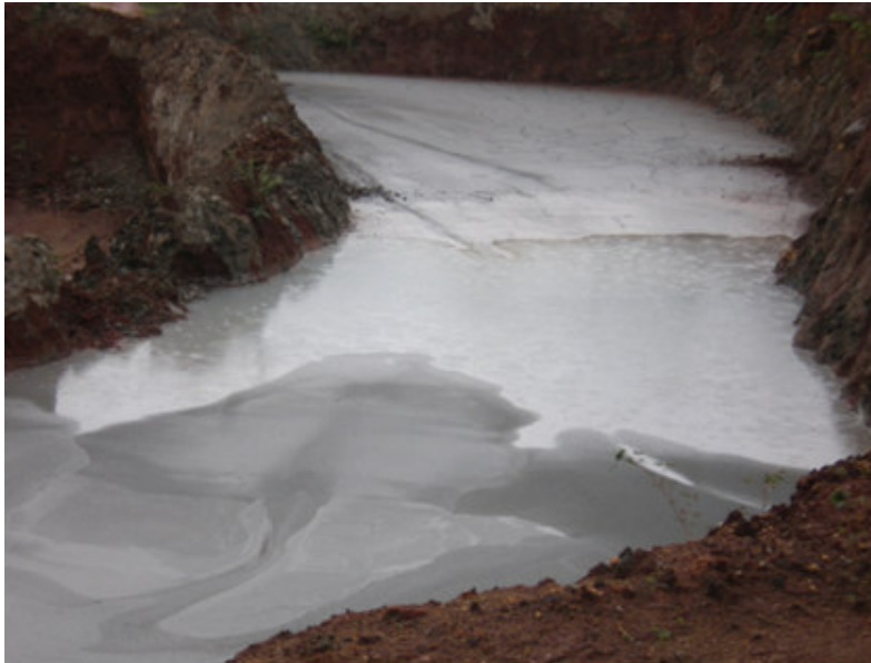
Figura 1: Poço de estocagem de resíduo de rochas ornamentais.
