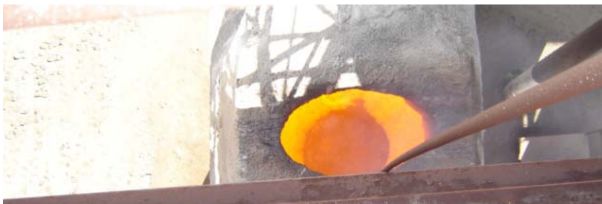
Figura 9 – Carro-torpedo com carga de sucata “C” de aciaria e pelota AR.
