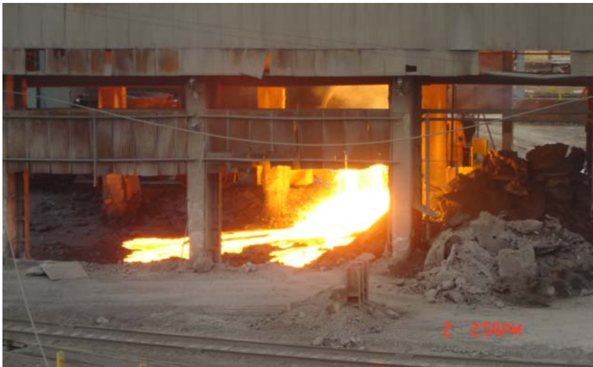
Figura 3 – Deposição de escória de aciaria para resfriamento na CSN.
