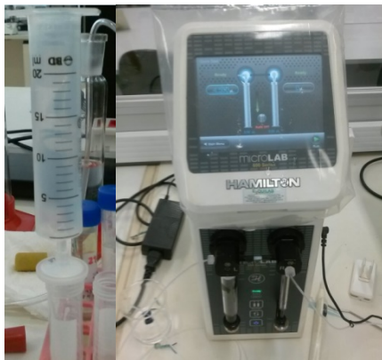
Figura 1 - Filtração das amostras para ICP-OES Figura 2 – Diluidor de amostras. (Próprio autor) com uso de seringa com filtro 0,22µ(micra) da Minisart. (Próprio autor)
