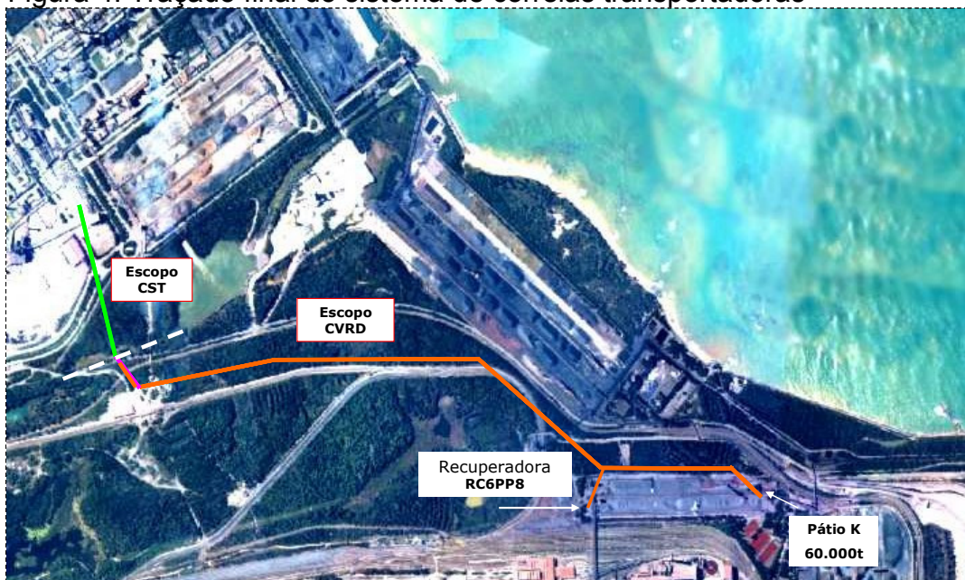
Figura 4: Traçado final do sistema de correias transportadoras
