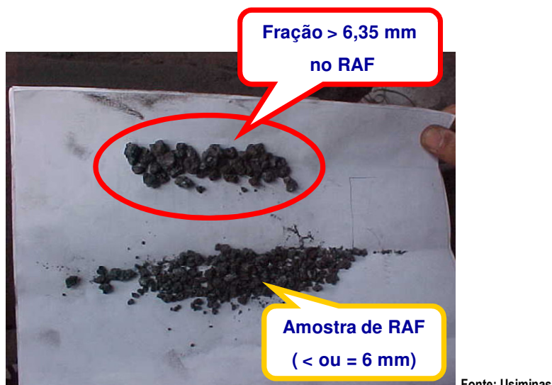
Fonte: Usiminas Figura 2 – Amostra de RAF e em destaque o material > 6 mm indevidamente junto ao RAF
