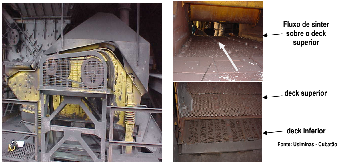
Figura 5 – Peneira vibratória de sinter (em destaque os decks da peneira).
