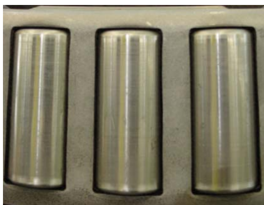
Figura 10. Situação do rolamento após o uso do lubrificante de alta performance
