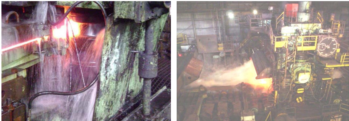
Figura 1. Ilustração do uso da água no processo de laminação a quente.
