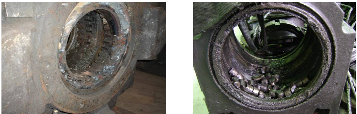
Figura 5. Situação de queima e travamento de mancais
