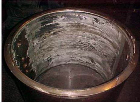
Figura 7: Bucha do mancal de encosto com arraste de metal patente, o que gerou travamento do mancal no laminador.
