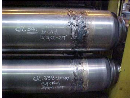
Figura 4: Cilindros de trabalho da cadeira #1 com incrustação de material após ocorrência de ondulado lateral.
