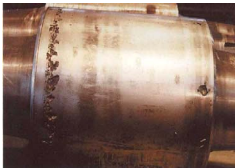
Figura 6: Cilindro de encosto com esfoliações na região das bordas geradas por fadiga de contato.
