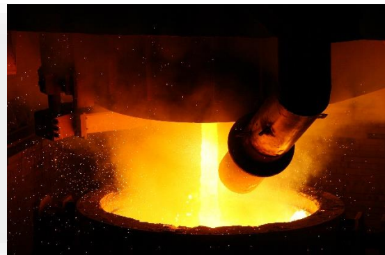
Figura 2. Vazamento de aço do FEA para panela.
