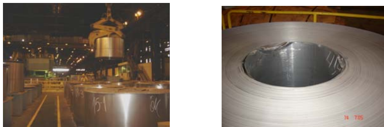
Figura 9. Colisão durante manuseio da bobina com bobinamento irregular
