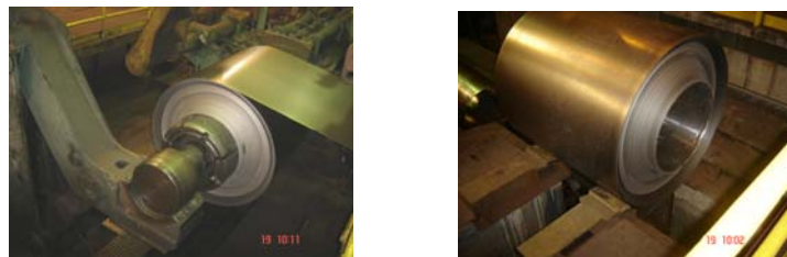
Figura 2. Defeito marca de deslizamento durante desbobinamento
