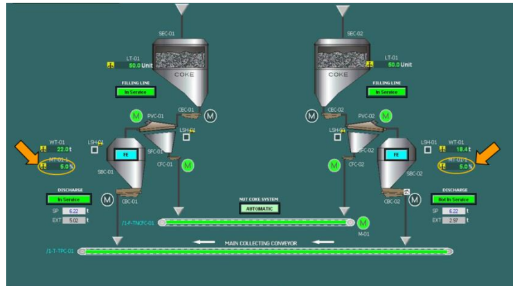
Figura 2: Sistema silo, peneira, balança de coque. Destaque para a medição de umidade.
