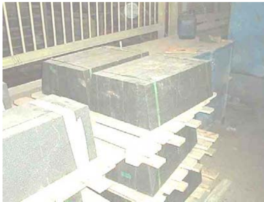
Figura 12. Projeto novo das peças refratárias para frente e atrás das ventaneiras.
