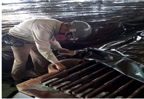
Figura 2. Medição de temperatura
