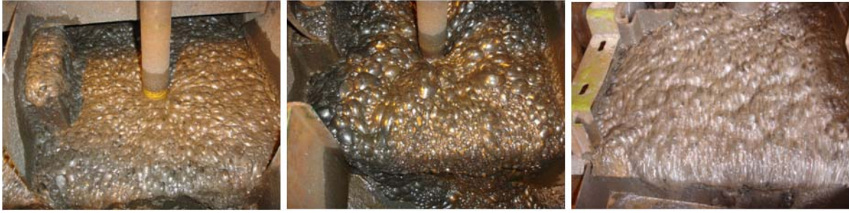
Figura 1. Aspectos da espuma de flotação nas etapas rougher , cleaner e scavenger , respectivamente.
