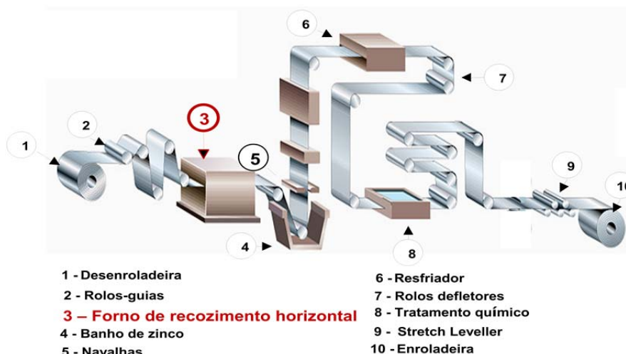
Figura 1. Esquemático da linha de zincagem e pote de zinco.
