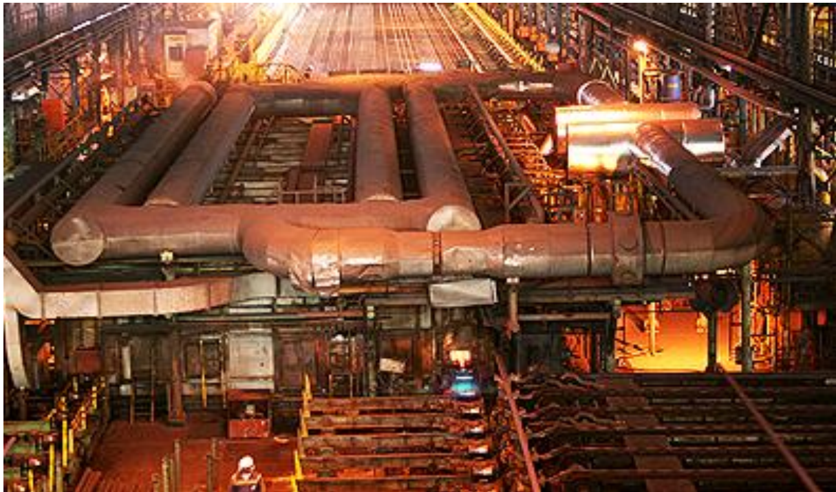
Figura 2 – Forno de Reaquecimento de Lupas (NWO)
