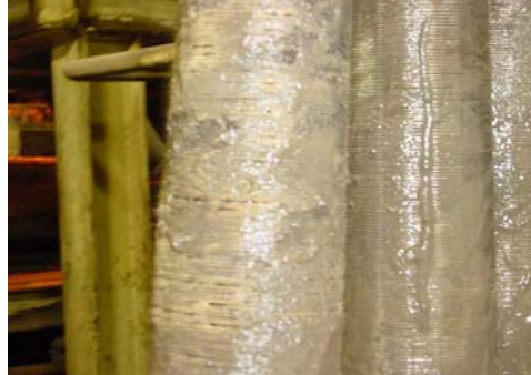
Figura 4. Depósito encontrado no filtro rotativo auto-limpante da aciaria 2.
