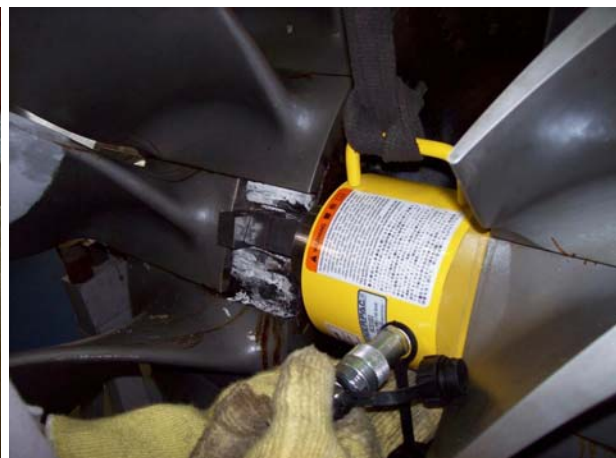
Figura 9 – Testes realizados para definição da resina de trava das palhetas.
