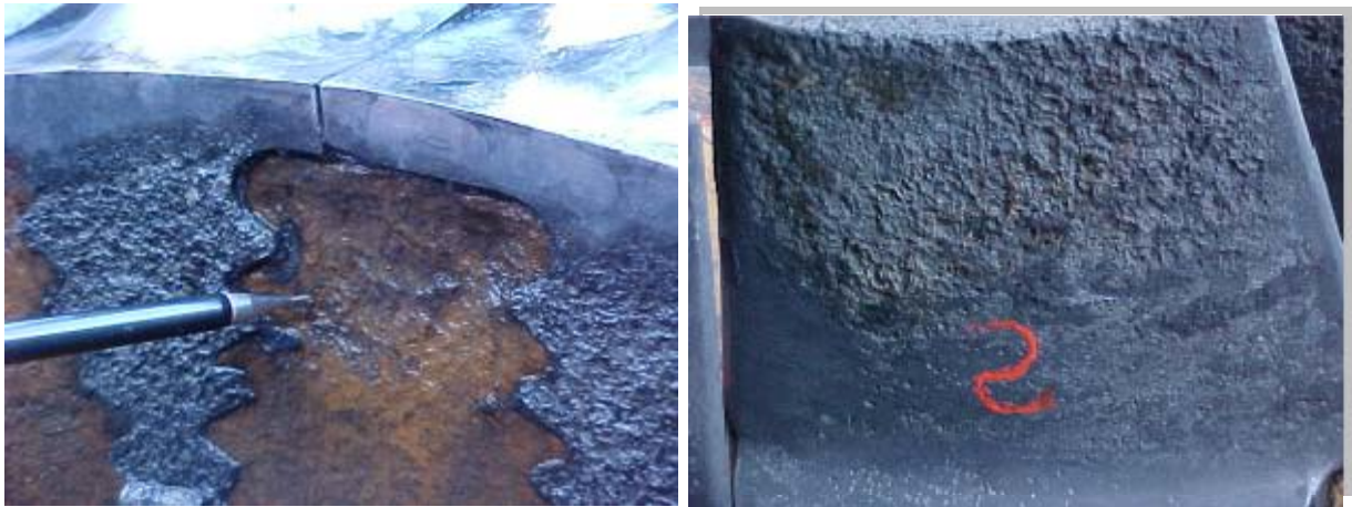
Figura 5 – Desgastes identificado nas palhetas durante a parada de 2002.
