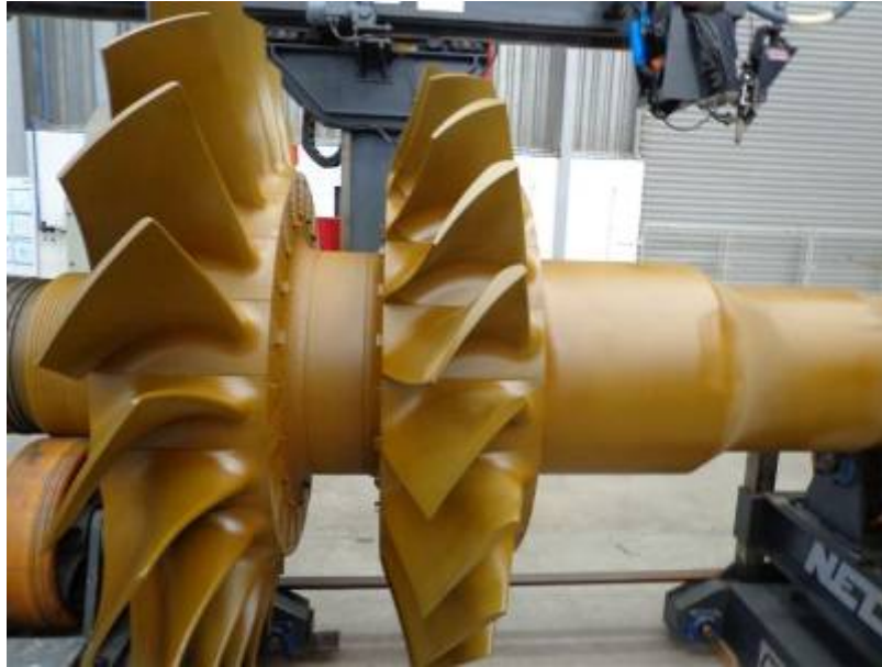
Figura 10 – Rotor da turbina recuperado.
