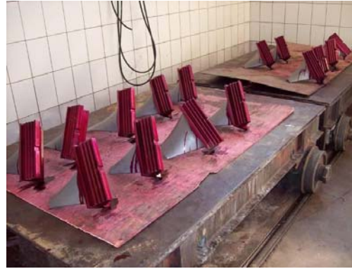
Figura 8 – Ultra som no eixo e ensaio de líquido penetrante nas palhetas.
