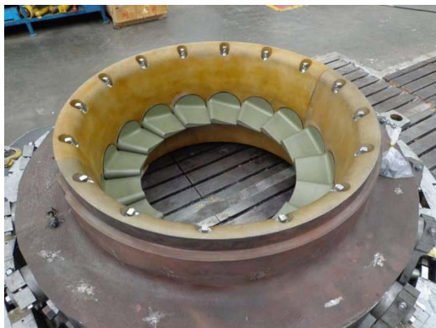
Figura 13 – Conjunto do estator blade recuperado e montado.
