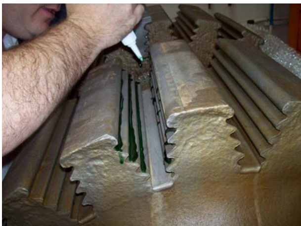
Figura 9 – Testes realizados para definição da resina de trava das palhetas.
