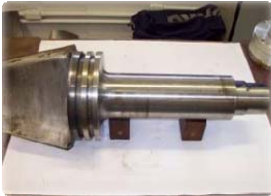
Figura 11 – a - Palheta velha com desgaste; b - Palheta nova
