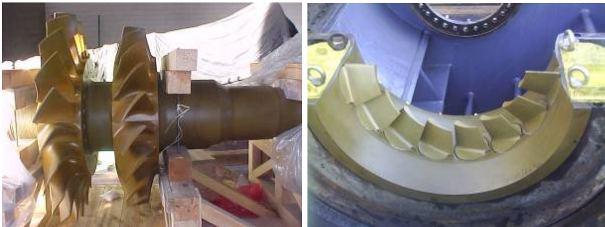
Figura 6 – Novos conjuntos de rotor e estator blade da turbina de topo instalados na reforma de 2006.
