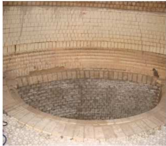
Figura 13 – Câmara de combustão reparada.
