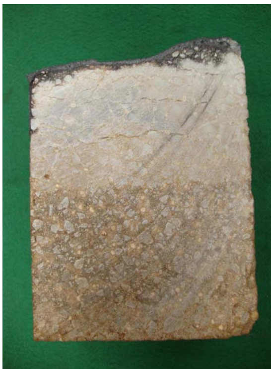
Figura 1. Refratário Básico Isento de Cromo usado no Vaso Inferior (lado de descida) do Desgaseificador RH da Planta A. Amostra após corte.
