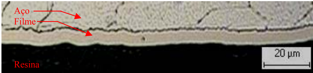
Figura 3 - Fotomicrografia de uma amostra recoberta com Ni-10%P tratada termicamente a 400^\circ\text{C} por 1h.
