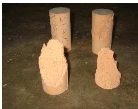
Figura 11 – Mostra do corpo de prova após rompimento.
