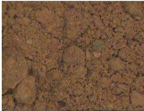
Figura 7 – Microscopia óptica do agregado miúdo cerâmica vermelha Mag. 80X (em relação à tela do computador).
