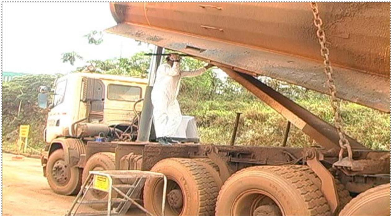
**Figura 4 –** Manutenção no sensor do inclinômetro.
