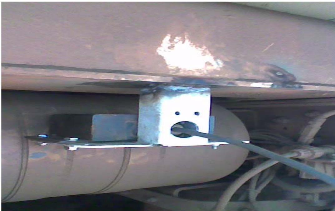
**Figura 8.** A foto mostra o sensor instalado na traseira do caminhão rodoviário.
