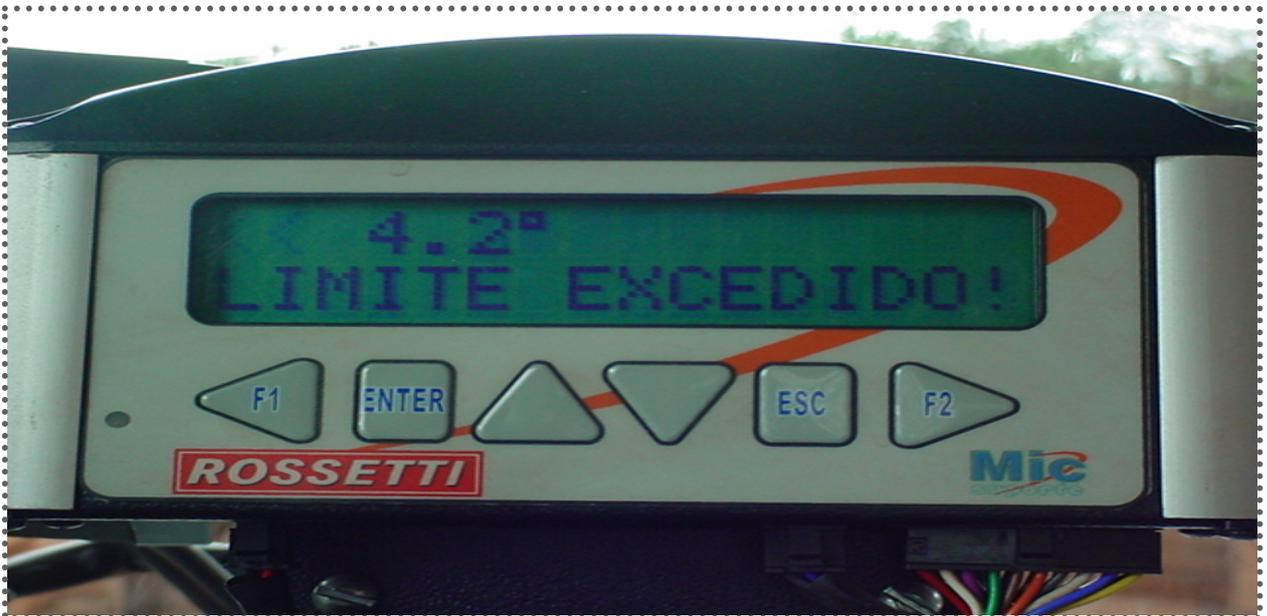
Figura 2. A foto mostra o display do sensor do inclinômetro instalado na cabine do caminhão.
