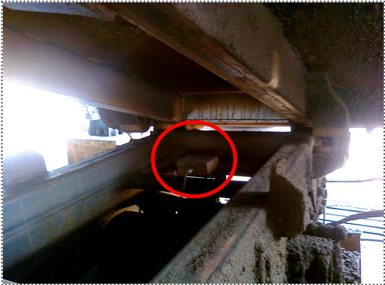
Figura 1. A foto mostrar a localização do sensor do inclinômetro no caminhão.
