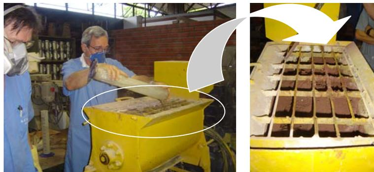
**Figura 4:** Misturado de eixo horizontal.<sup>(2)</sup>
