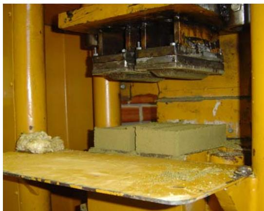
**Figura 5:** Prensa hidráulica.<sup>(2)</sup>
