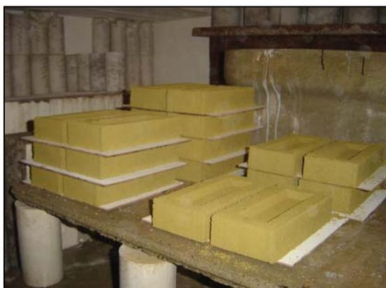
**Figura 6:** Cura dos tijolos prensados.<sup>(2)</sup>
