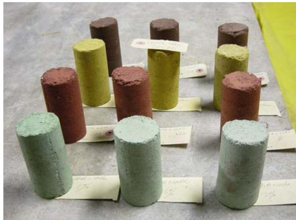
**Figura 8:** Pigmentação dos tijolos.<sup>(2)</sup>
