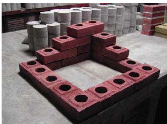
**Figura 10:** Assentamento do tijolo com furos sem argamassa. <sup>(2)</sup>
